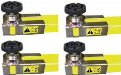
B90 Gummiaufnahmen bleiben auf den Hubarmen befestigt
